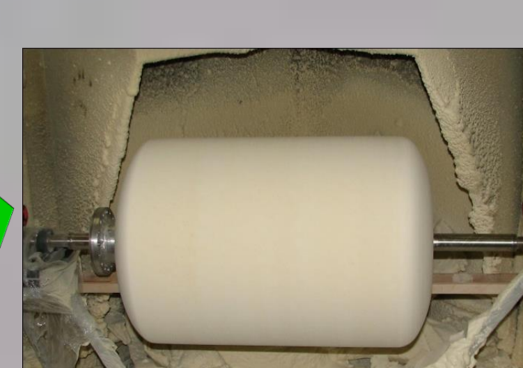
UV novecošanās testi sākotnēji pēc 5 nedēļām
